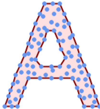
多点的凹面外壳，允许有孔
